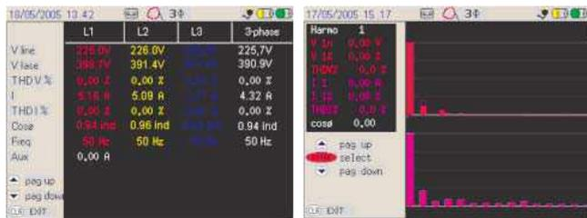
**\* Harmonics 측정 :** IEC61000-4-7 규정에 의거해 전압 및 전류를 31차수까지 측정한다. 고조파는 바그래프 및 수치로 표시된다. 각각의 고조파는 절대값과 기본값에 대한 퍼센트를 표시하고, 전압과 전류고조파 사이의 변위각을 포함한다.
